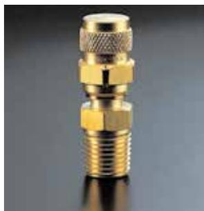
Серия клапанов VPV разработана для ручного дренирования, отвода воздуха и спуска жидкости из системы. Крышка завальцована вокруг корпуса клапана для безопасной эксплуатации. Дренажное отверстие диаметром 1,6 мм (0,063 дюйма) выполнено в крышке.
