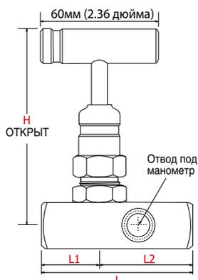
Клапаны с выходом под манометр
