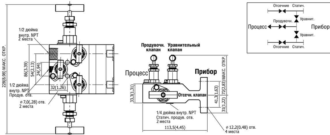
Непосредственная установка с двумя фланцами
