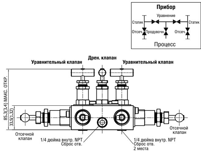
Непосредственная установка с одним фланцем
