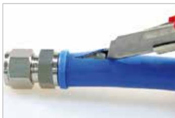
1. Снимите шланг из системы и надрежьте его примерно в 1см от синего колпака.
