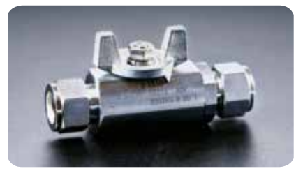
Кран с рукояткой-бабочкой Рабочее давление • Седла из PTFE: 68.9 бар (1000 фунт./кв.дюйм) • Седла из TFM не применяются
