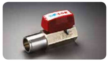
Кран с диэлектрической рукояткой Рабочее давление • Седла из PTFE: 68.9 бар (1000 фунт./кв.дюйм) • Седла из TFM: 137 бар (2000 фунт./кв.дюйм)
