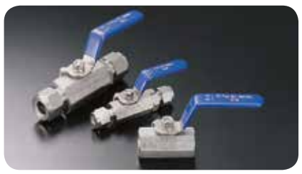
Кран с рычажной рукояткой Рабочее давление • Седла из PTFE: 68.9 бар (1000 фунт./кв.дюйм) • Седла из TFM: 137 бар (2000 фунт./кв.дюйм)
